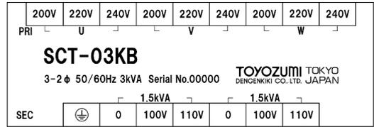
当製品はスコット(3 - 2)トランスです。2次側の各相には90度の位相差があり、シリーズ(直列)・パラ(並列)結線にての使用はできません。又、2次側の両相を同時(定格電流以下にて)に平衡負荷使用されない場合、1次側各相の電流が不平衡となります。
