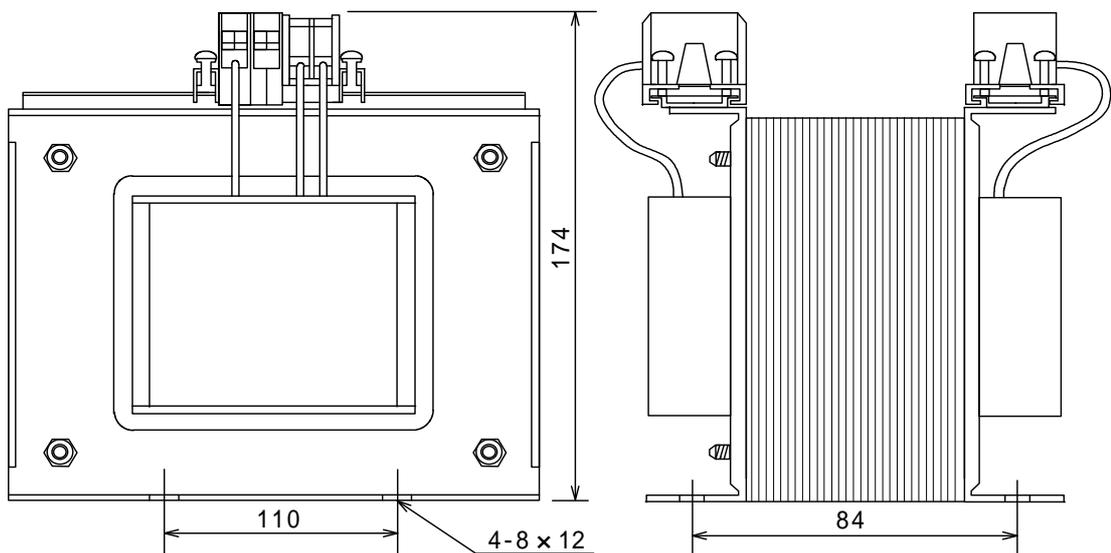
適合規格 : EN61558-2-4 2009 (機器用乾式・非短絡耐性トランス、Class 1、IP00)
