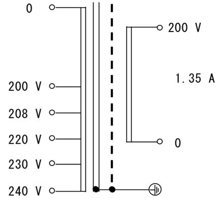
安全の為、又規格に適合させる為、トランス外部に保護機器を接続して下さい。(保護の適合性は最終製品にて判定して下さい)
