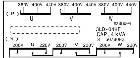
出荷時の2次(S)側ショートバーは相記号(u,v,w)端子と200V端子間に設定しております。相記号(u,v,w)端子へ負荷を接続しご使用下さい。
