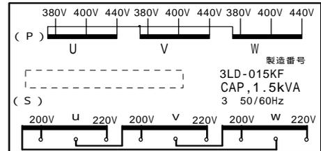
出荷時の2次(S)側ショートバーは相記号(u,v,w)端子と200V端子間に設定しております。相記号(u,v,w)端子へ負荷を接続しご使用下さい。
